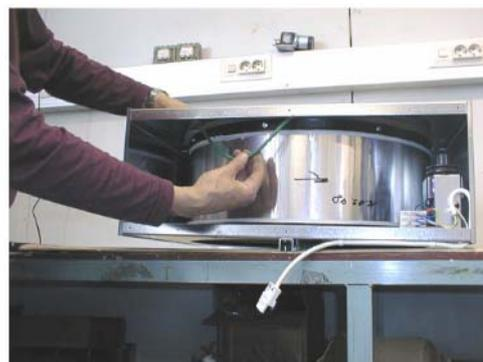
Abb. 3 und 4 Aufziehen des Riemens
