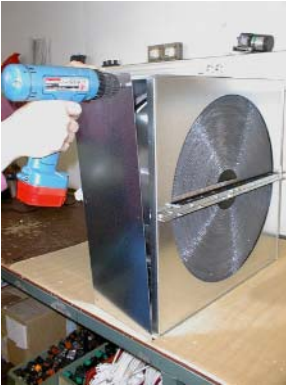
Bild 1 Locket med 6 st skruvar öppnas
