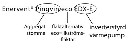
eco Ventilationsaggregat med likströmsfläktar och EDA-styrssystem.
