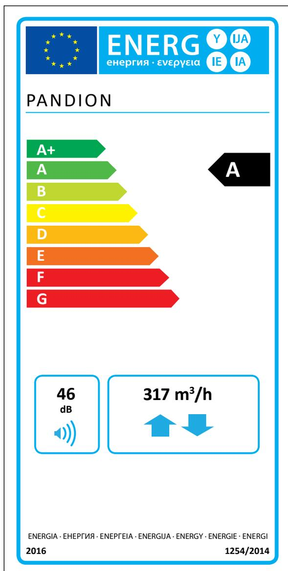
Les informations présentes sur l'étiquette énergétique pour ce produit ont été définies avec une régulation de la puissance appelée. Une régulation de la puissance appelée signifie que le système de ventilation règle en continue la ou les vitesses des ventilateurs et les débits à partir de plus d'un capteur. N'oubliez pas de raccorder tous les capteurs locaux (certains vendus en option) afin d'obtenir la classe énergétique déclarée.
