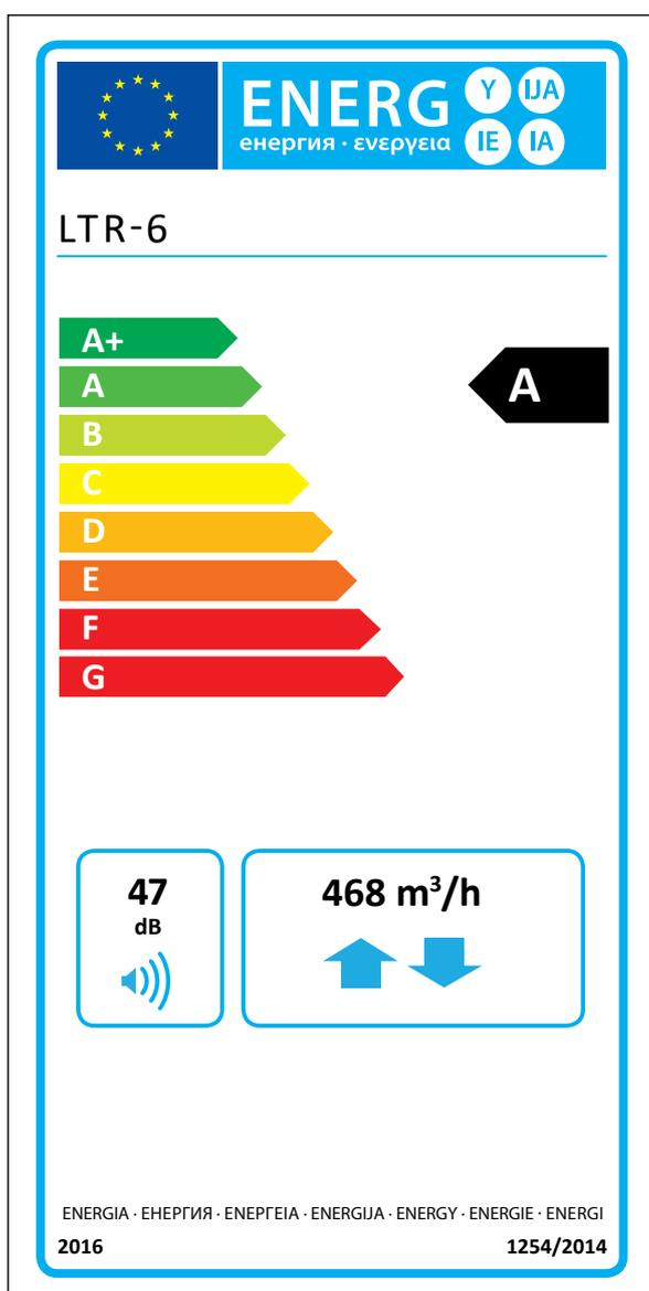
Die Information auf dem Energie-Label für dieses Produkt wurde anhand der örtlichen Nachfragesteuerung definiert. Örtliche Nachfragesteuerung bedeutet, dass die Lüftungseinheit die Gebläsegeschwindigkeit und den Luftdurchsatz kontinuierlich anhand mehrerer Sensoren reguliert. Bitte beachten, dass alle lokalen Sensoren anzuschließen (teilweise als Zubehör erhältlich) sind, um die deklarierte Energieeffizienzklasse zu erreichen.
