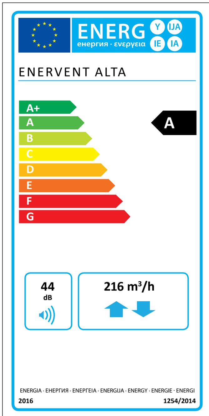
Die Information auf dem Energie-Label für dieses Produkt wurde anhand der örtlichen Nachfragesteuerung definiert. Örtliche Nachfragesteuerung bedeutet, dass die Lüftungseinheit die Gebläseschwindigkeit und den Luftdurchsatz kontinuierlich anhand mehrerer Sensoren reguliert. Bitte beachten, dass alle lokalen Sensoren anzuschließen (teilweise als Zubehör erhältlich) sind, um die deklarierte Energieeffizienzklasse zu erreichen.
