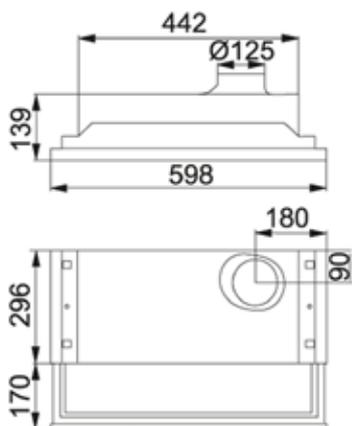
Hotte avec filtre à charbon actif conçu pour être encastré dans le meuble. Ce modèle a un couvercle coulissant et un signal d'indication à l'unité.
