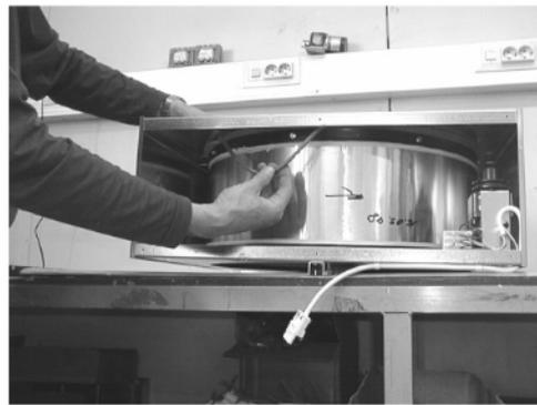
Abb. 3 und 4 Aufziehen des Riemens
