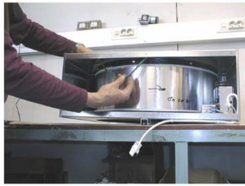
Abb. 3 und 4 Aufziehen des Riemens
