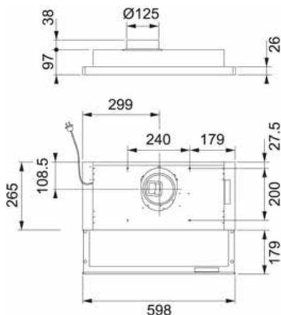
Diese Premium-Dunstabzugshaube ist für die Einbettung in die Möbel vorgesehen. Die elektronischen Schalter befinden sich in der ausziehbaren Front. Dieses Modell verfügt über eine elektrisch schließende Klappe und ein Anzeigesignal für das Gerät. Die Farboptionen für die vordere Liste sind weiß und Edelstahl.
